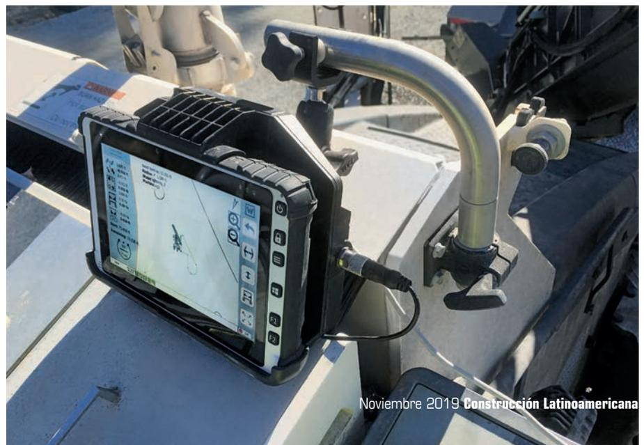
obras viales es el Auto Pilot 2.0, un sistema de referencia de informaciones del suelo que presenta datos en 3D para obras de pavimentación.
