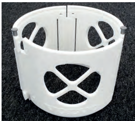
Una herramienta de taller de Volvo CE, hecha con impresión 3D, para montar piezas en un eje.
