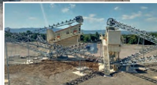
La Nordplant 5.1 fue seleccionada porque permite un montaje rápido y con un único punto de contacto.
