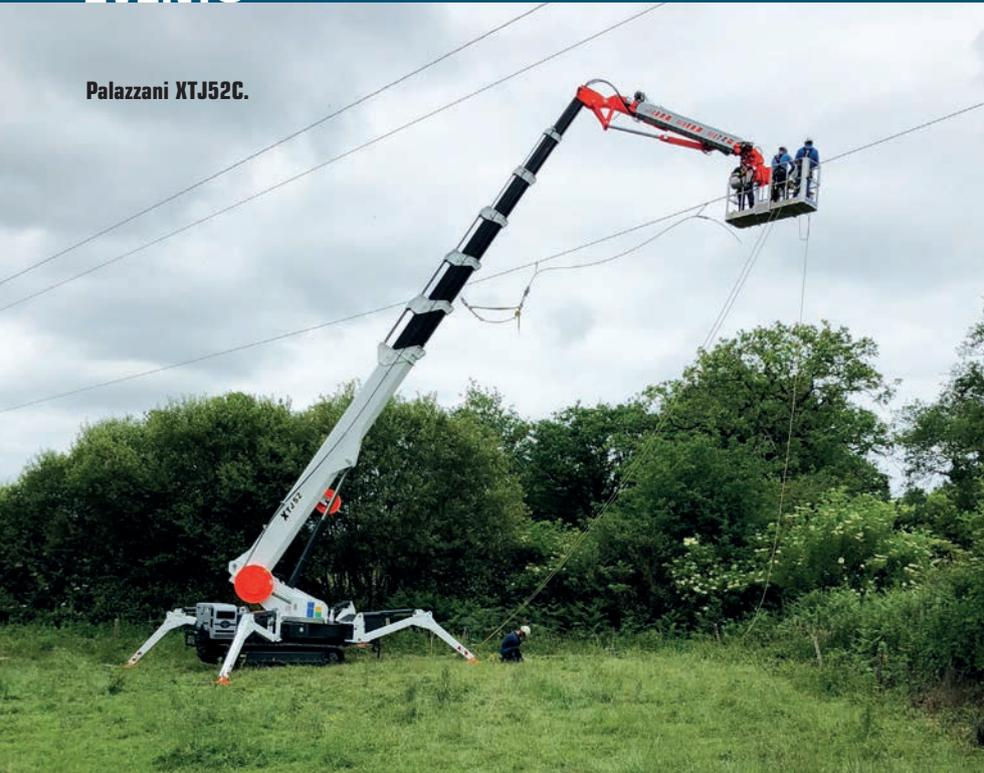
aproximadamente 21 ° y una configuración de con el estabilizador hidráulico permite trabajar en pendientes de hasta un 30% o en escaleras. Hay una opción de cuatro tamaños de plataforma diferentes
