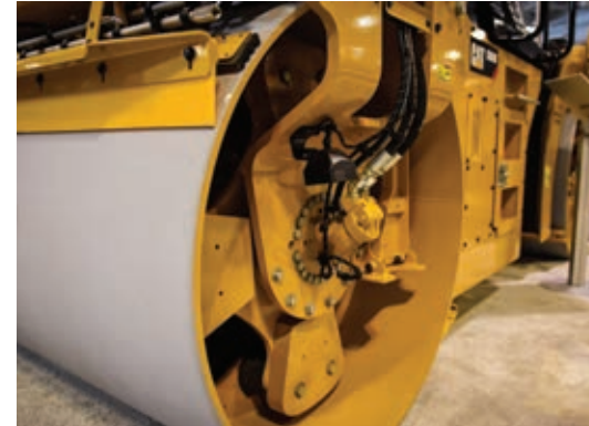
Na Conexpo, a Caterpillar mostrou a nova capa externa, heavy duty, para os tambores de rolos compactadores.
