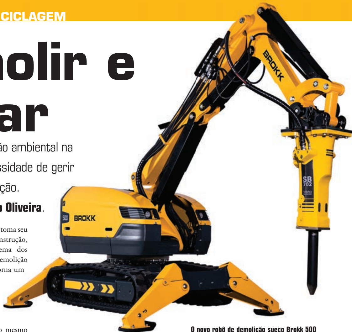
O novo robô de demolição sueco Brokk 500 manteve suas dimensões compactas mas agregou 40% de potência de golpe.
