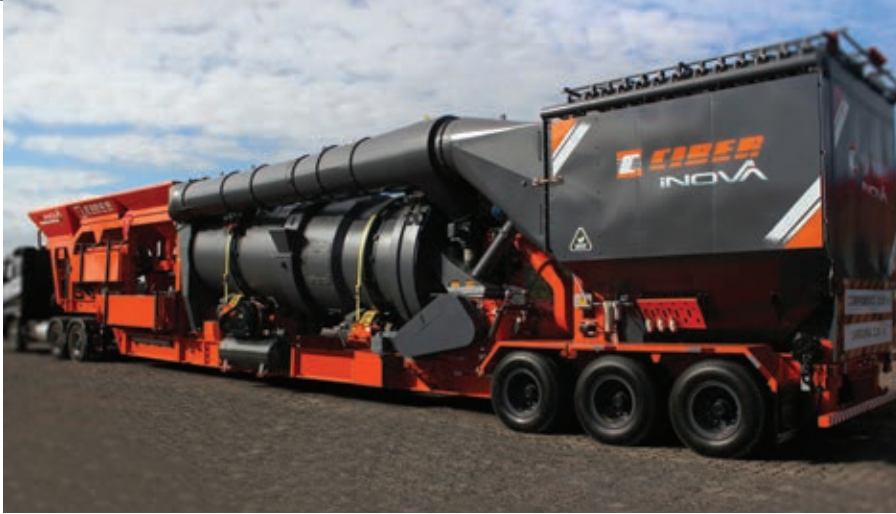
As novas usinas de asfalto da Ciber receberam sistemas que permitem melhor secagem de agregados e mais controle do abastecimento de ar para o secador.
