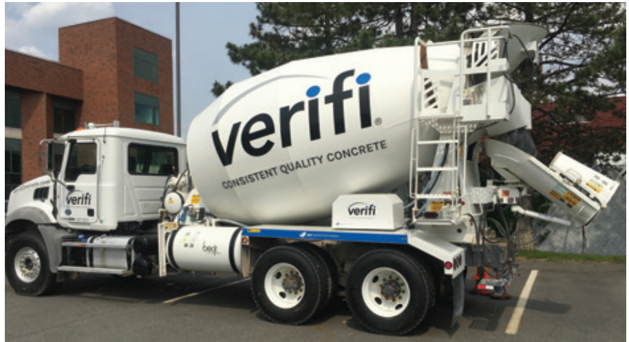
El sistema compensa el slump durante el transporte a través de mediciones precisas y cálculos digitales.
