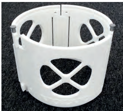
Ferramenta do laboratório da Volvo CE, feita com impressão 3D, para montar peças em um eixo.
