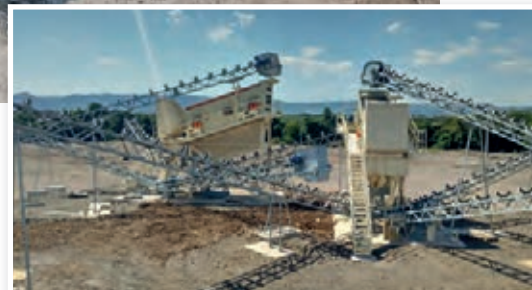
A Nordplant 5.1 foi escolhida porque permite montagem rápida e com um único ponto de contato.
